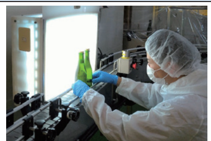
【产品检查】使用检查灯进行目视检查
